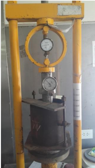
ENSAYO DE COMPACTACIÓN DE SUELOS (VN-E5-93)
